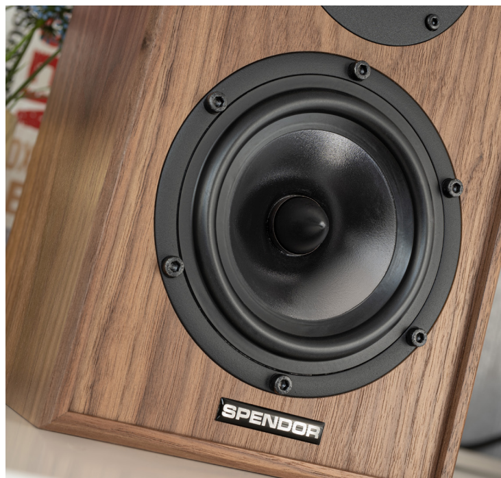
Auch wenn der Tief-/Mitteltontreiber „nur“ 140 Millimeter im Durchmesser misst, spielt die Spondor erstaunlich weit (und sauber) in den Bassbereich hinein.
